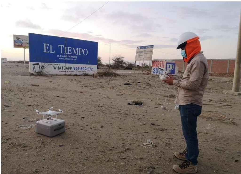
Fotografía 8. Levantamiento fotogramétrico con dron Phantom 4 Pro de intersección “La Campana” de Talara, Piura
