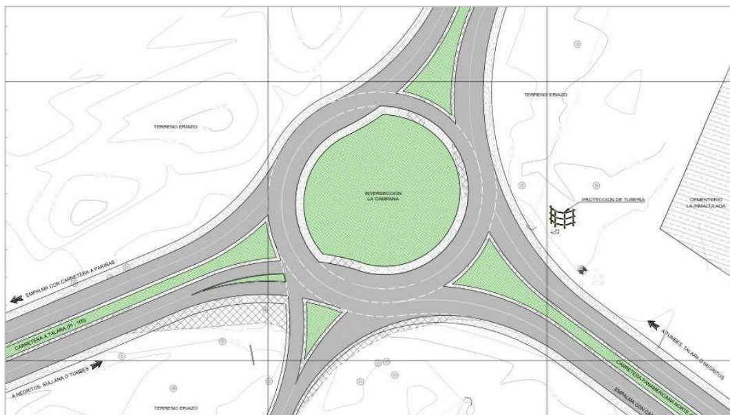
Figura 20: Afinación de la turbo rotonda - intersección La Campana, Talara, Piura
