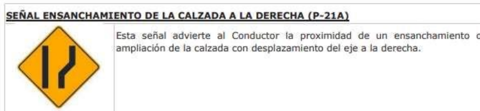
Figura 26: Señal de ensanchamiento de carril (MTC-2018)
