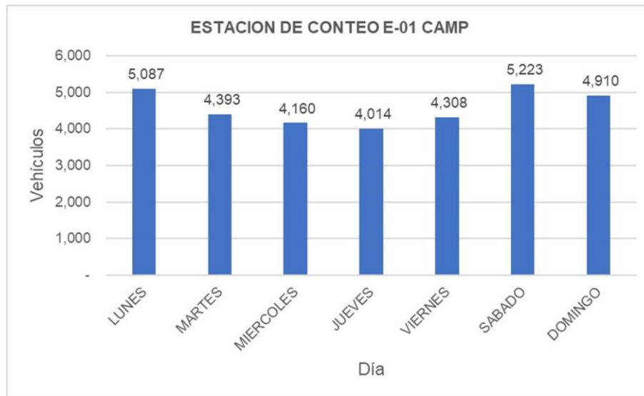
Figura 13: Vehículos totales contabilizados - intersección La Campana, Talara, Piura.
