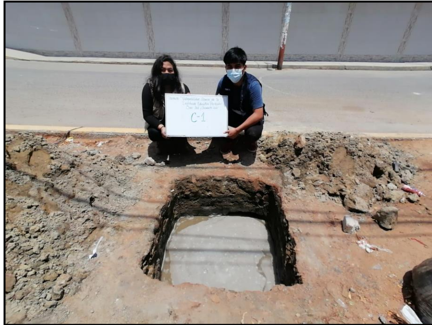
Figura 15: Calicata 1 – Muestra para EMS
