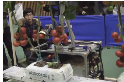
図7 第6回大会優勝チーム Hibikino-Tom's (九州工業大学)。トマト果実を吸引し切断する機構を装備。
