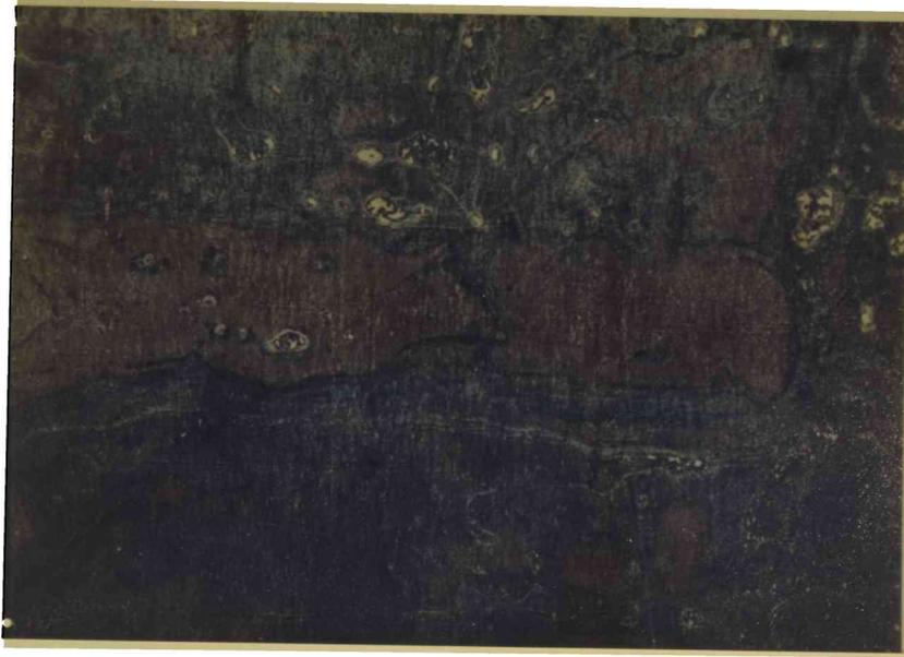
*Figura 2.- Superficie de acero con la escama de laminación intacta, prácticamente sin corrosión (tipo A, Norma SIS 05 59 00 - 1967)*
