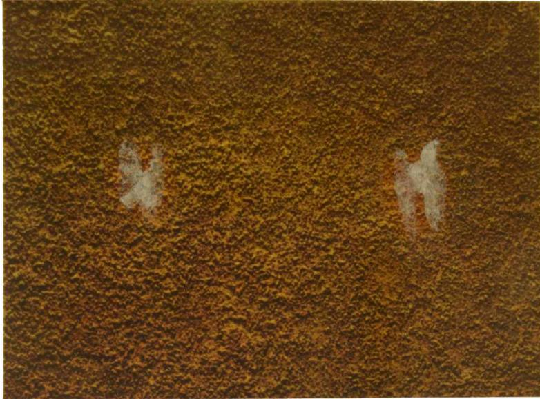
*Figura 3.- Superficie de acero en la que la escama de laminación se ha eliminado por corrosión (tipo C, Norma SIS 05 59 00 - 1967)*
