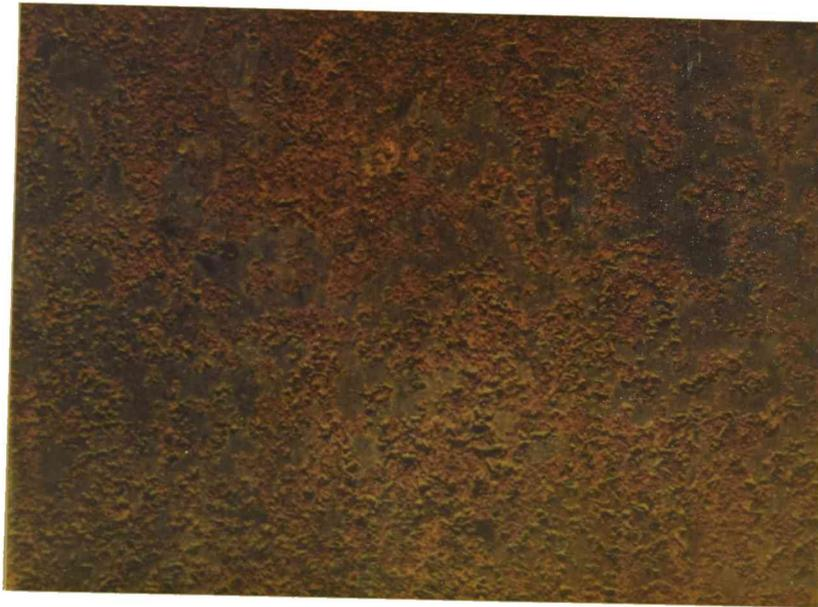
*Figura 3.- Superficie de acero en la que la escama de laminación ha comenzado a desprenderse, con principio de ataque (tipo B, Norma SIS 05 59 00 - 1967)*
