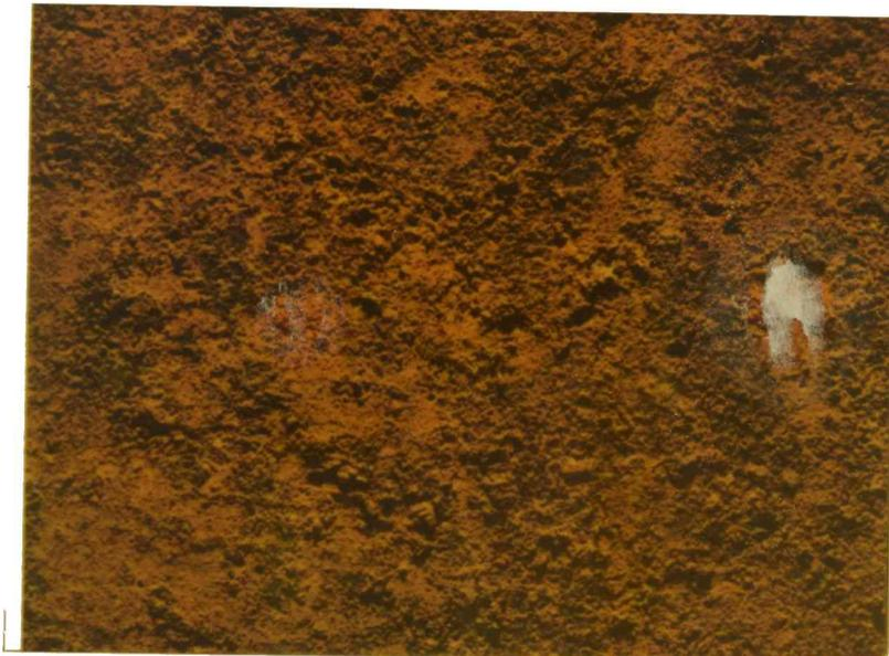
*Figura 4.- Superficie de acero luego de la eliminación de la escama de laminación; proceso de corrosión avanzado, con picado (tipo D, norma SIS 05 59 00 - 1967)*
