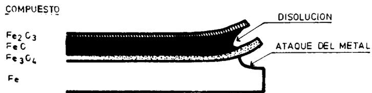
Figura 11.- Efecto del decapado sobre la escama de laminación producida por debajo de los 570°C
