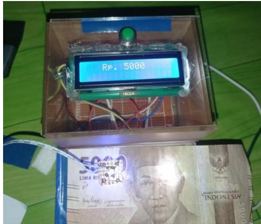
Gambar 11. Pengujian terhadap objek uang kertas pecahan Rp 5000.
