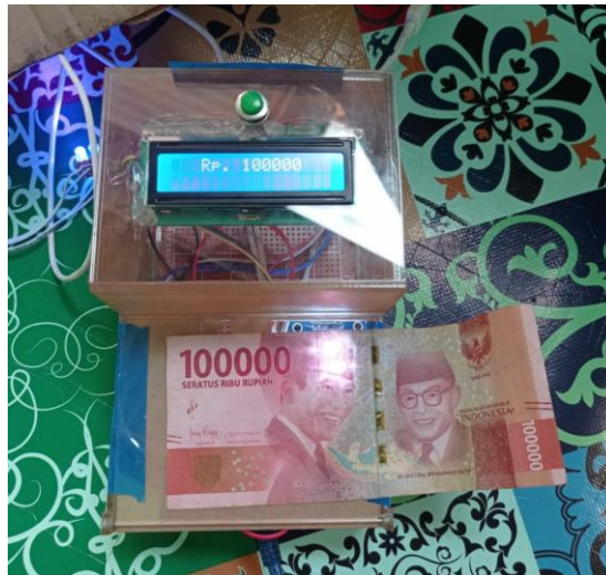
Gambar 15. Pengujian terhadap objek uang kertas pecahan Rp 100.000.
