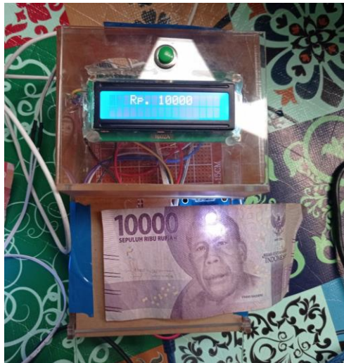
Gambar 12. Pengujian terhadap objek uang kertas pecahan Rp 10.000.
