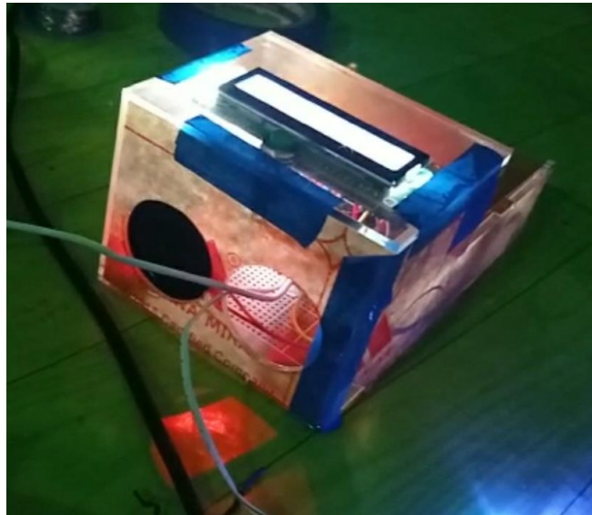
Gambar 8. Hasil jadi perancangan alat pendeteksi uang beserta output speaker.
