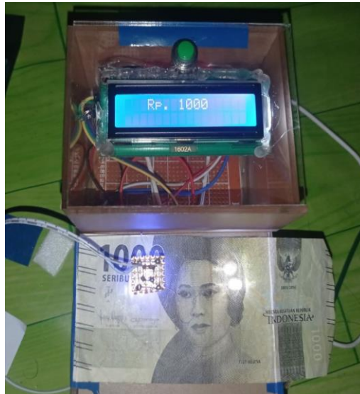
Gambar 9. Pengujian terhadap objek uang kertas pecahan Rp 1000.
