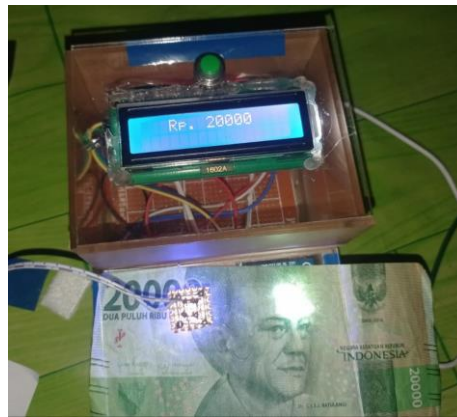
Gambar 13. Pengujian terhadap objek uang kertas pecahan Rp 20.000.
