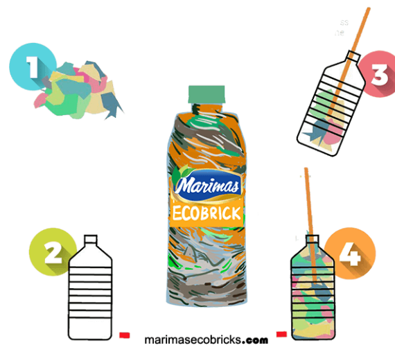
Gambar 3.1 Langkah Pembuatan Ecobricks (sumber:marimas ecobriks.com)
