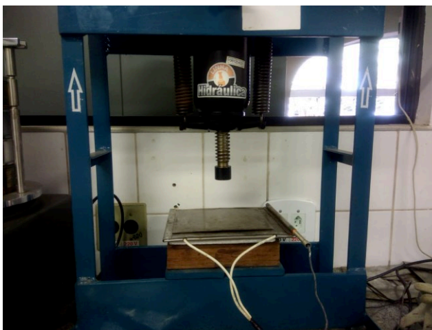
Figura 10. Imagem da prensa hidráulica e chapas com aquecimento utilizadas para prensar e secar os filmes.
