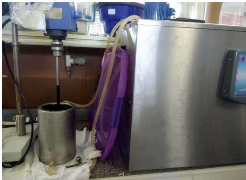
Figura 6. Imagem do sistema utilizado para síntese do polipirrol.
