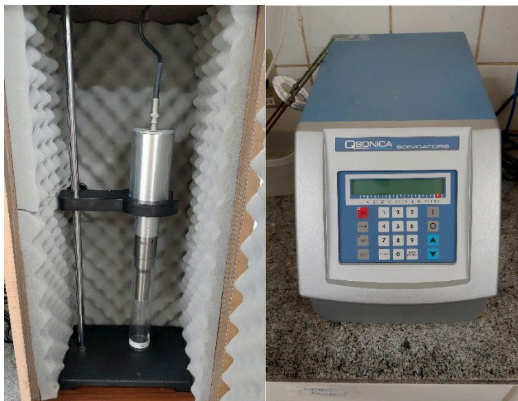
Figura 7. Imagem do processador ultrassônico utilizado para esfoliação do óxido de grafeno.
