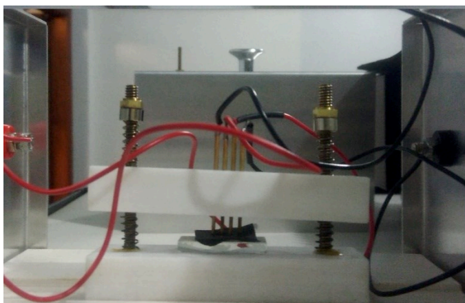
Figura 12. Arranjo dos eletrodos utilizados para aplicar a corrente e medir o potencial nas amostras pelo método de quatro pontas.
