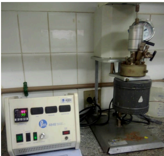
Figura 8. Imagem do reator utilizado na redução do óxido de grafeno com hidrazina.
