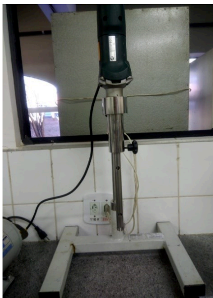
Figura 9. Imagem do equipamento ultra turrax utilizado para homogeneizar as soluções dos filmes.
