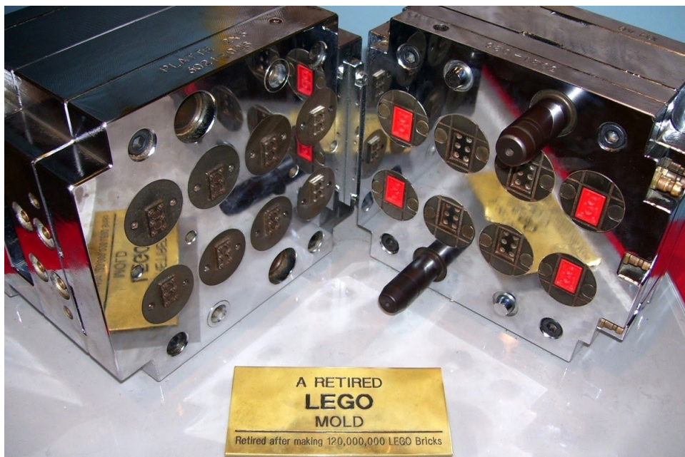
Figura 6. Molde de peças de Lego® aposentado após 15 milhões de ciclos
