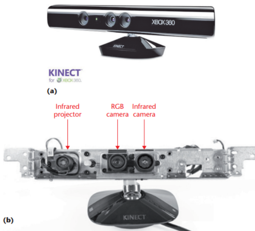
Figura 16 – (a) é uma imagem do Xbox 360 Kinect e (b) é uma representação da localização da câmera RGB, câmera de raios infravermelhos e do projetor de raios infravermelhos.
