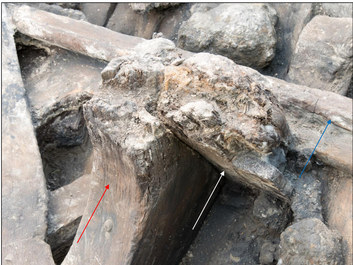
Figuur 10. Het restant van de dekbalk (witte pijl) is nog verbonden met de dekknie (rode pijl). Achter beide scheepsdelen is het in-situ gelegen lijfhout zichtbaar (blauwe pijl) (Y.T. van Popta, RUG/GIA).
