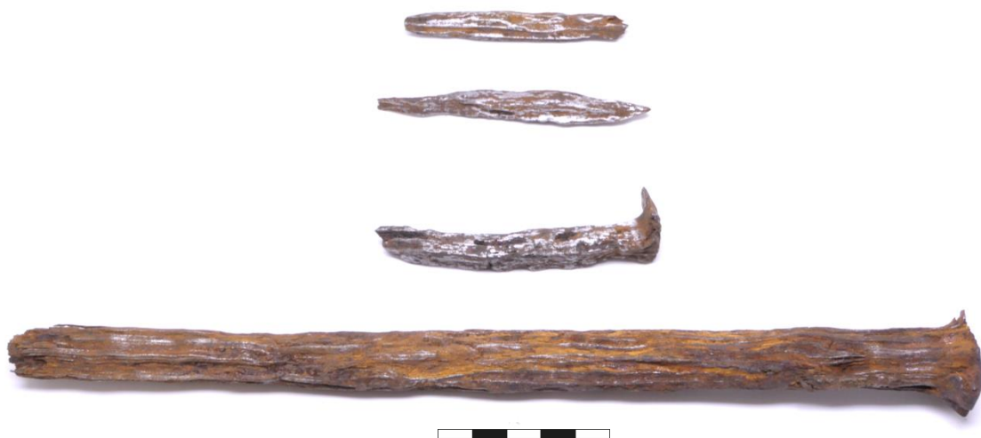
Figuur 43. Van boven naar onder: drie spijkerfragmenten (vnr. 35, 4, en 24r) en de bout (vnr. 14) na het verwijderen van de corrosie (Y.T. van Popta, RUG/GIA).
