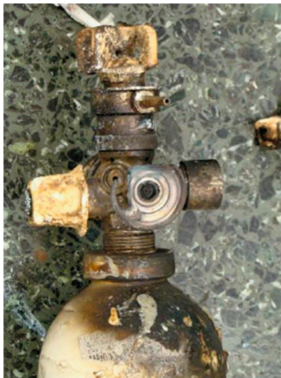
FIGUUR Foto van een uitgebrande zuurstofcilinder met reduceerventiel. De hoofdafsluiter van het reduceerventiel bevindt zich bovenin, de flowregelaar in het midden. De brand ontstond bij het openen van de hoofdafsluiter terwijl de flowregelaar al geopend was.
