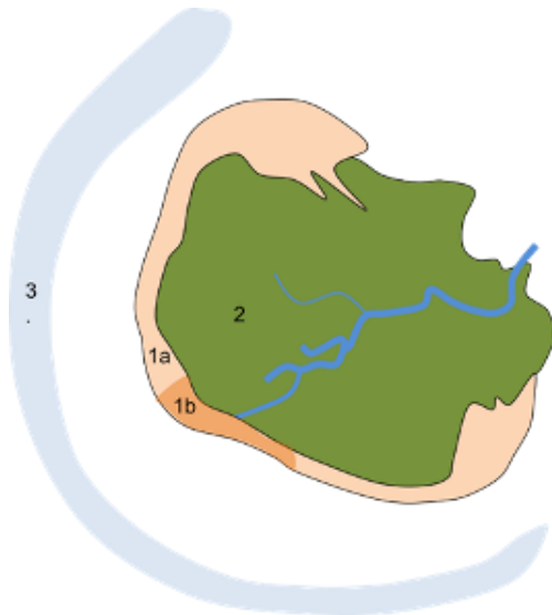
Figuur 2.2. Model stormvloed-schoorwaleiland met 1a) stormvloed-schoorwal, 1b) washover/geulcomplex, 2) achtergelegen kwelder met kreken en 3) zwin-geul aan de geëxponeerde kant van het eiland als gevolg van golfreflectie. Gebaseerd op huidige luchtfoto's van Zuiderduintjes en historische luchtfoto's van Griend.
