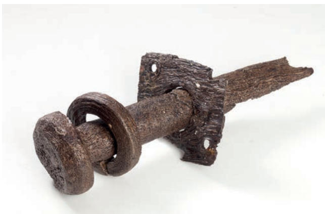
AFBEELDING 6.6 De zwaardbout van OH41: 'de Ventjager', eerste kwart 18 e eeuw. De lengte van de bout is 19,5 cm bij een doorsnede van 25 mm. De doorsnede van de kop bedraagt 53 mm en deze is 18 mm dik. (vondstnummer OH41-174, Beeldbank RCE).
