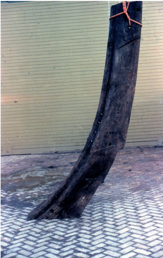
AFBEELDING 8.6 De gekromde voorsteven van de ZL1 met diepgangsmarken.
