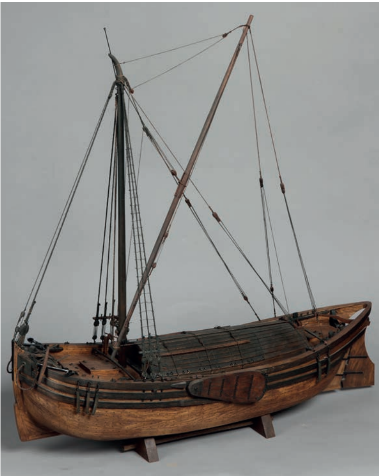
AFBEELDING 6.7 Scheepsmodel gebaseerd op wrak OB71 (het beurtschip) en aangevuld op basis van iconografische bronnen van het sprietzeil (Fries Scheepvaartmuseum, inv. nr. FSM-2011-067).
