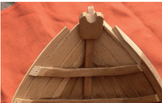
AFBEELDING 6.4 Reconstructiemodel van de Almere kogge. Tegen de voorsteven zit een blok bevestigd, dat vermoedelijk gefunctioneerd heeft als miek voor de mast.
