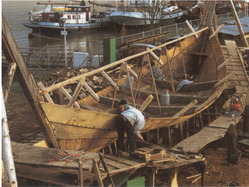
AFBEELDING 6.2 Bij de bouw van de Kamper kogge is de bottom-based bouwvolgorde gehanteerd. Nadat de belangrijkste leggers (hoofdspanten) op het vlak zijn bevestigd, worden de huidplanken door middel van klampen tijdelijk op hun plaats gehouden (foto: Stichting Kamper kogge).
