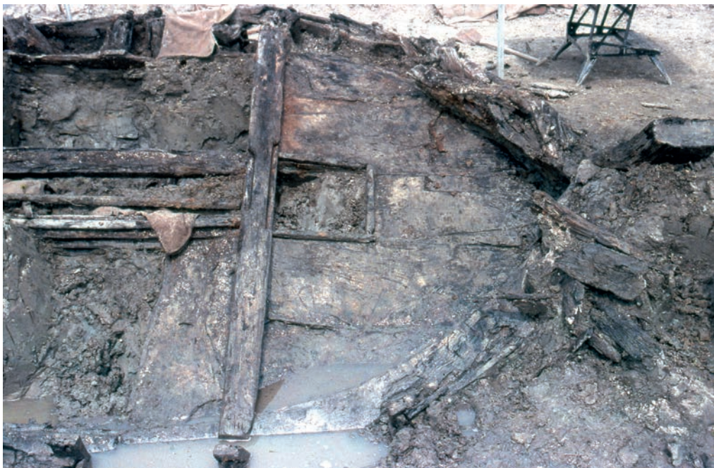
AFBEELDING 8.7 Afbeelding voordek ZL1 met links direct achter het luik de twee schaarbalken waartussen de masthiel kantelde.
