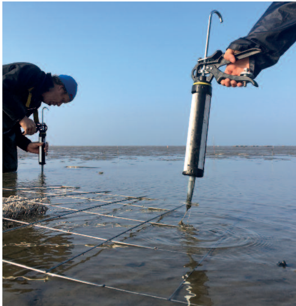
Foto 6. De kitspuit-methode om zeegraszaad in de wadbodem te spuiten (foto: Laura Govers).
