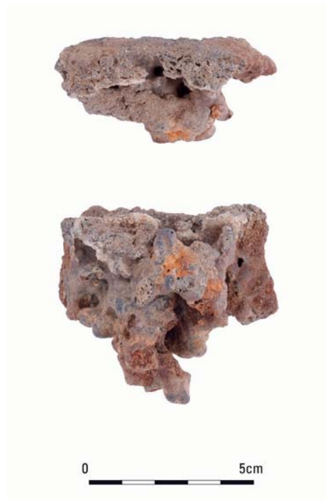
Afb. 13.1 Cuijk-De Nielt. Boven- en vooraanzicht van een fragment van een productieslak (V43.14034) uit een kuilslakoven, gevonden in het Vroeg-Romeinse huis 8033 (S43.13236).
