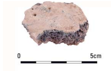
Afb. 8.8 Cuijk-De Nielt. Voorbeeld van een ovenwandfragment. Het verglaasde oppervlak en de gasbellen in de matrix zijn goed zichtbaar (V34.6866).
