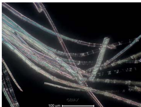
Afb. 12.30 Cuijk-De Nielt. Vlasvezels van het textielfragment van Cuijk-De Nielt (V15436, 2010-1 volgvel 22, groep II/1). Microfoto in gekruist gepolariseerd licht (200x). Zichtbaar zijn de kenmerkende eigenschappen van vlasvezels: het dunne centrale lumen (of kanaal) en de x-vormige verschuivingen over de lengte van de vezels. De vezels zijn fijn tot middelfijn met een diameter van ca. 8,5 tot 17 µm. De vezels zijn geïdentificeerd door vergelijking met recente vezels in de vergelijkingscollectie van BIAZ Consult en een moderne vezelatlas (Catling & Grayson 1998).
