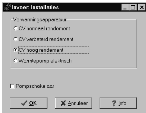
Figuur 11 Invoervenster voor de verwarmingsapparatuur
