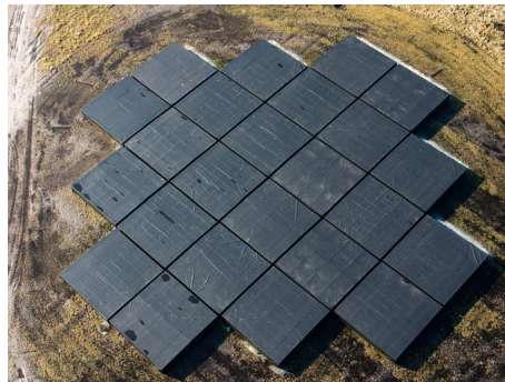
Figuur C.2: Vierentwintigtegelige HBA opstelling: Elke tegel is een element van een HBA station. Deze opstelling wordt gebruikt in veruit de meeste HBA stations die LOFAR rijk is, inclusief de stations op de superterp , het centrum van LOFAR nabij Exloo. Een opstelling als deze telt veel redundante basislijnen.
