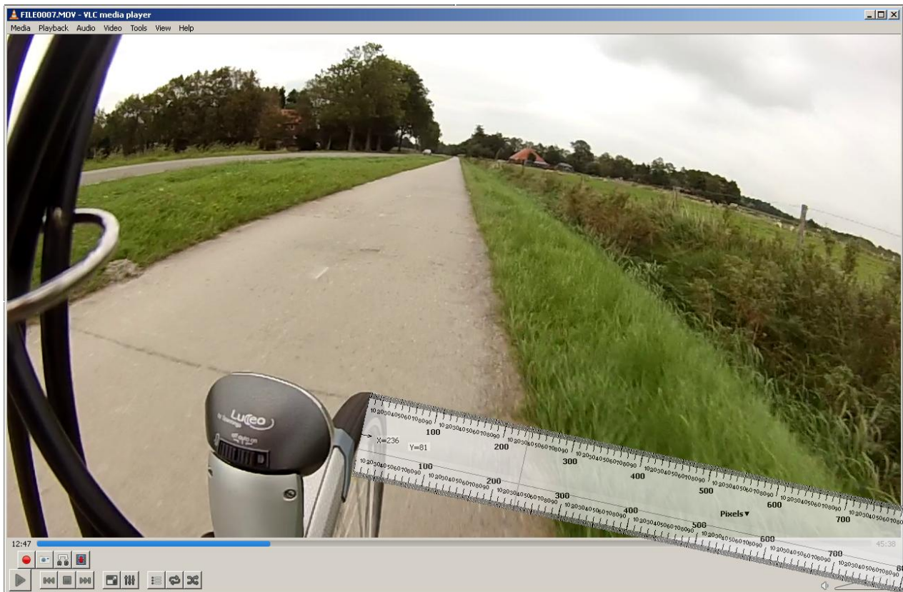
Figuur 6: Een afbeelding van een filmfragment van een fietser op een betonplaten fietspad waarbij de liniaal is uitgelijnd aan de dwarslijnen van de scheiding van de betonplaten.
