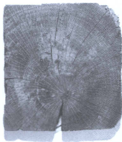
De doorsnede van een zestiende-eeuwse eikenhouten balk. De jaarringen zijn duidelijk zichtbaar, al valt het niet altijd mee om ze te tellen, laat staan om hun precieze dikte te bepalen. Dendrochronologen meten de ringdiktes met behulp van een microscoop tot op een honderdste millimeter.
