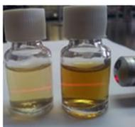
**Figura 1.** Solución de nanopartículas de plata obtenidas utilizando extracto de epazote.
