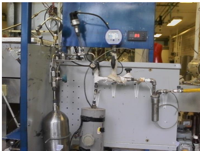
Figura 3. Sistema de vacío basado en el método volumétrico para la evaluación de adsorción de un gas en un material.
