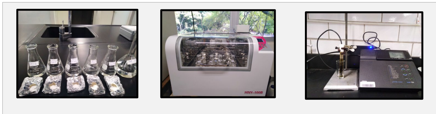
Figura 20. Fotografías del procedimiento para determinar las isotermas de adsorción del material adsorbente.
