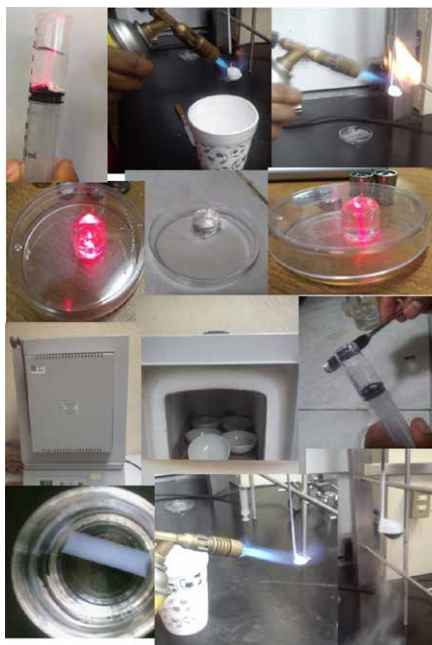
Figura 1. Rutas de síntesis para la elaboración de aerogeles.
