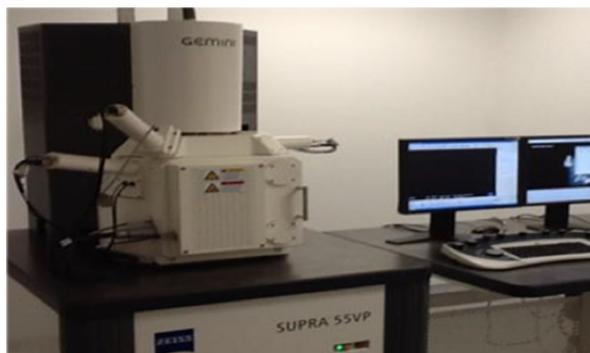
**Figura 5.** Microscopio Electrónico de Barrido SUPRA 55VP.
