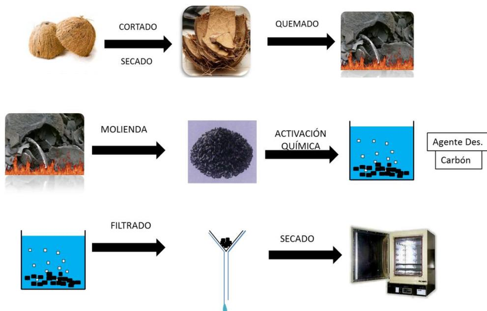
**Figura 2.** Proceso de activación del carbón.
