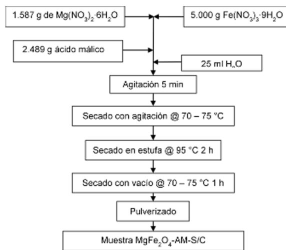
Figura 1. Diagrama de flujo para la preparación del precursor  $MgFe_2O_4$ -AM-S/C.
