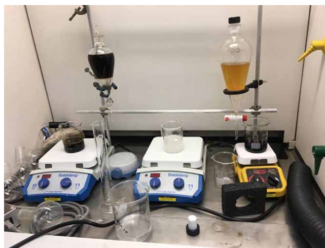
Figura 2. Extracción de cafeína a partir de las muestras de Coca-Cola® y Red Bull®.
