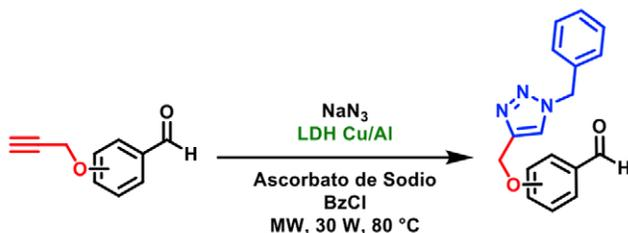
**Esquema 3.** Síntesis de triazoles asistida por microondas y catalizada por LDH Cu/Al.
