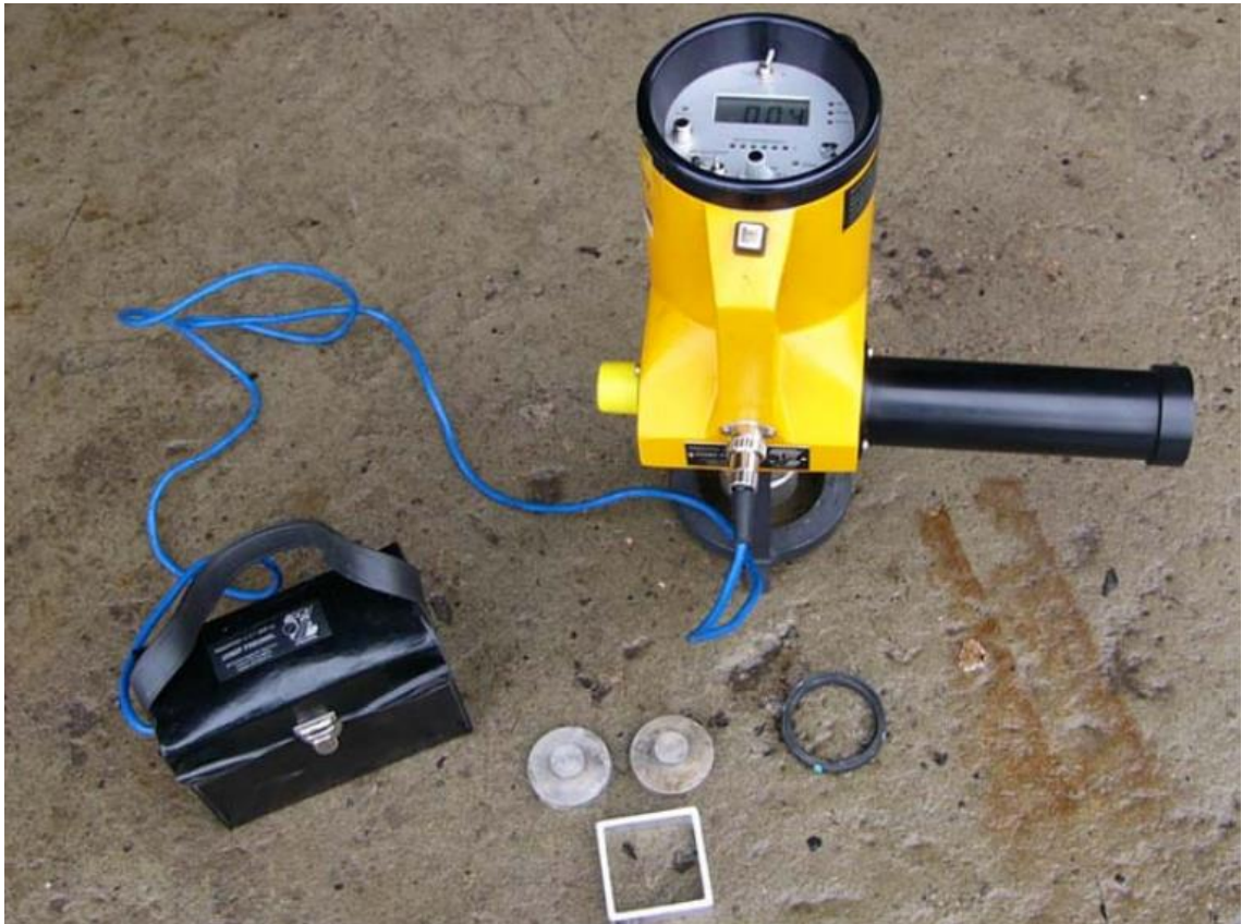
Kuva 9. Tartuntavetolaite (Liikenneviraston ohjeita 2/2017, s.19).
