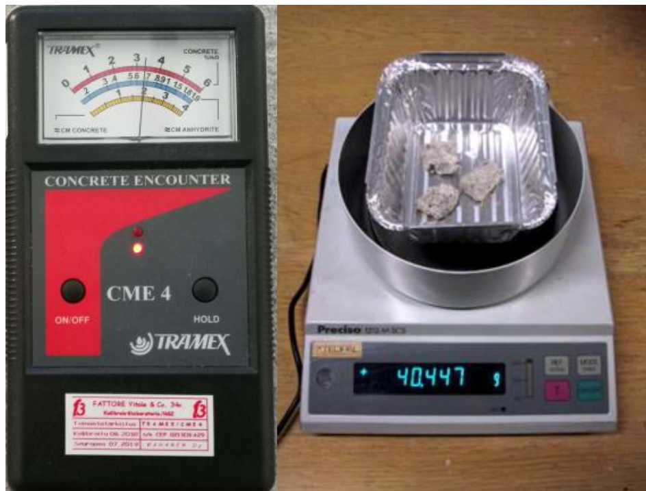
Kuva 7. Vasemmalla pintakosteusmittari ja oikealla puntari (Rateko 2021).
