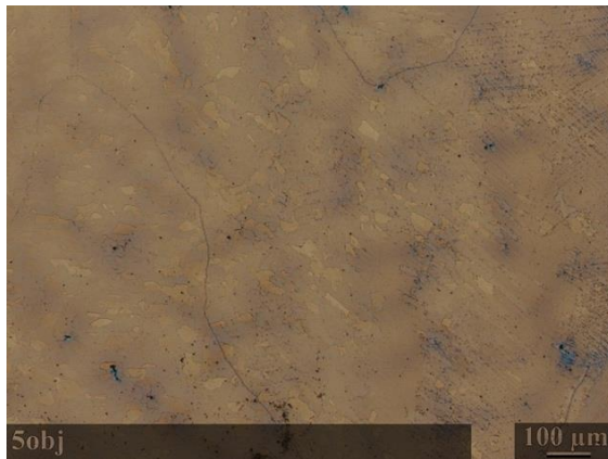
Kuva 33. Näytteen 2.3 simuloidun FGHAZ:in ja perusaineen raja.
