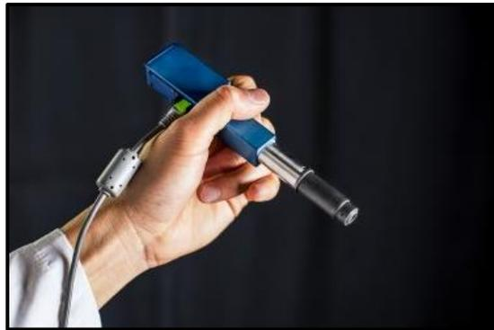
*Figura 12 - Microscópio miniatura [83].*
