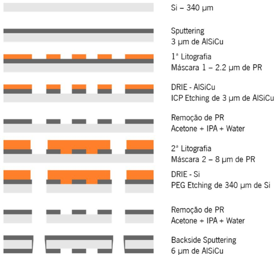
**Figura 73** – Processo de fabrico do guia de ondas proposto.
