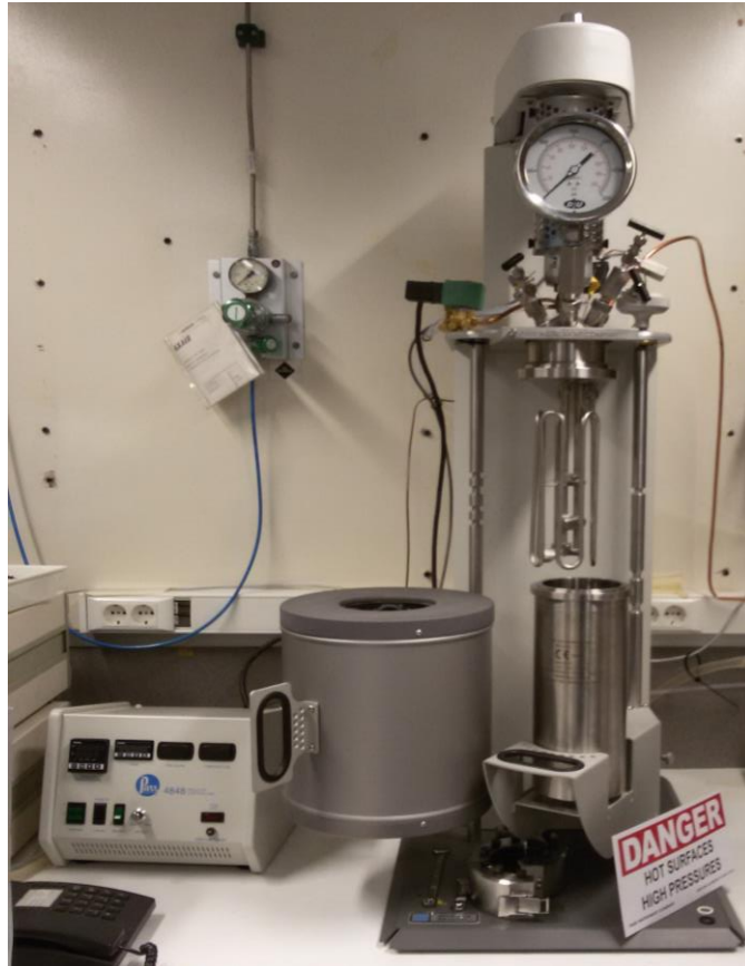
Figura 4 – Reator pressurizado (Parr Instruments Company, Moline, Illinois, USA), utilizado para efetuar o processo de autohidrólise da drêche.
