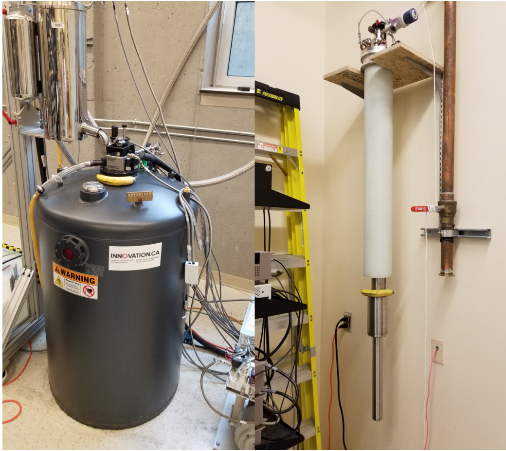
FIGURE 2.10 À gauche, nous avons un cryostat de type PPMS permettant d'atteindre des champs magnétiques de 16T et des températures de 2-400K. Le liquéfacteur d'hélium est présent sur la photo, en plus des nombreux fils de mesures. À droite, nous avons un VTI sorti de son socle permettant des températures de l'ordre de 2 jusqu'à 300 K d'une manière extrêmement stable. Pour l'échelle des deux systèmes, une banane est présente dans les deux images.
