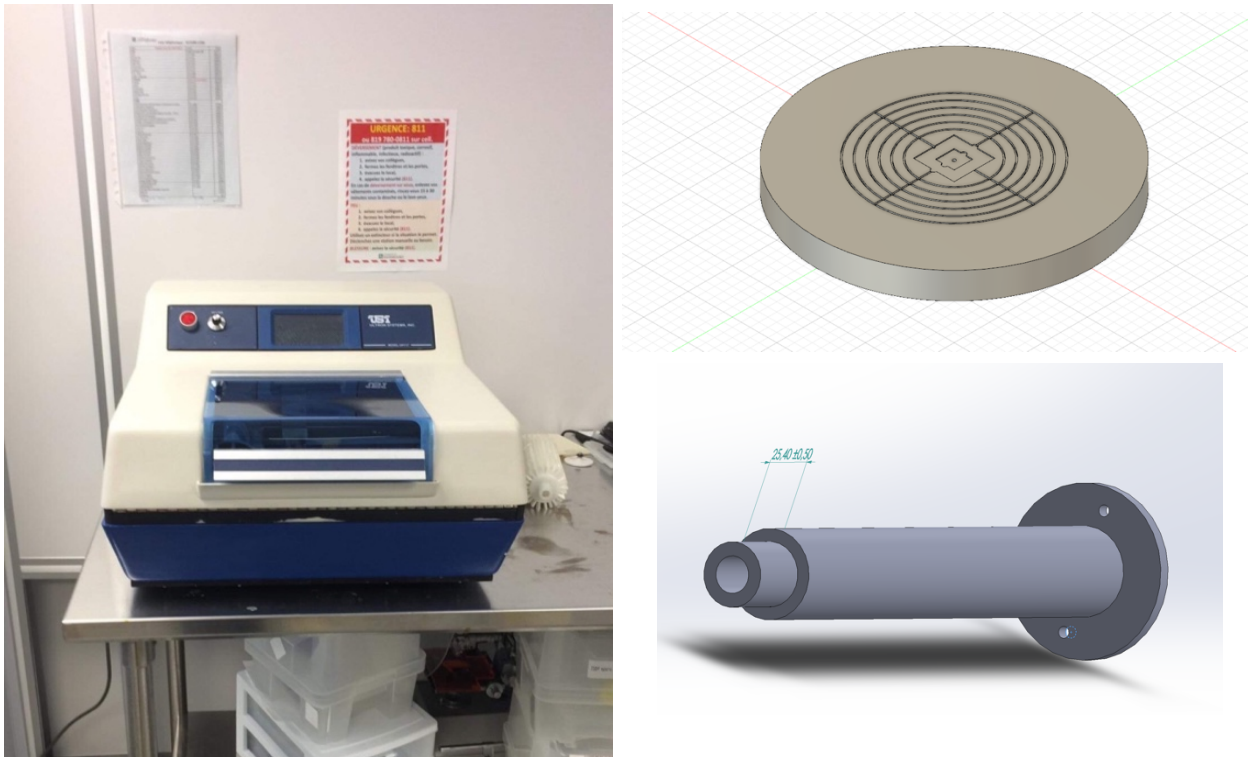
Figure 3.29 Système de nettoyage sur table avec axe de brosse et support d'échantillons sur mesures
