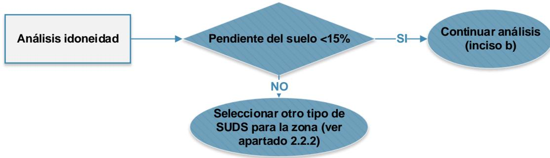
**Figura 5.2.** Proceso para el análisis de idoneidad de implementación.
