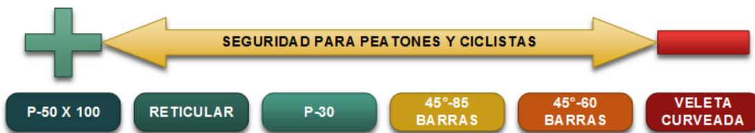
**Figura 2.27.** Clasificación de seguridad de rejillas para peatones y ciclistas adaptado de Brown et al. (2013)
