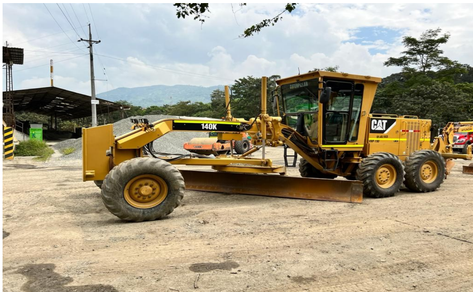
Figura 31. Motoniveladora de tipo 140K
