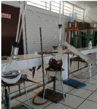
Extracción por arrastre de vapor
