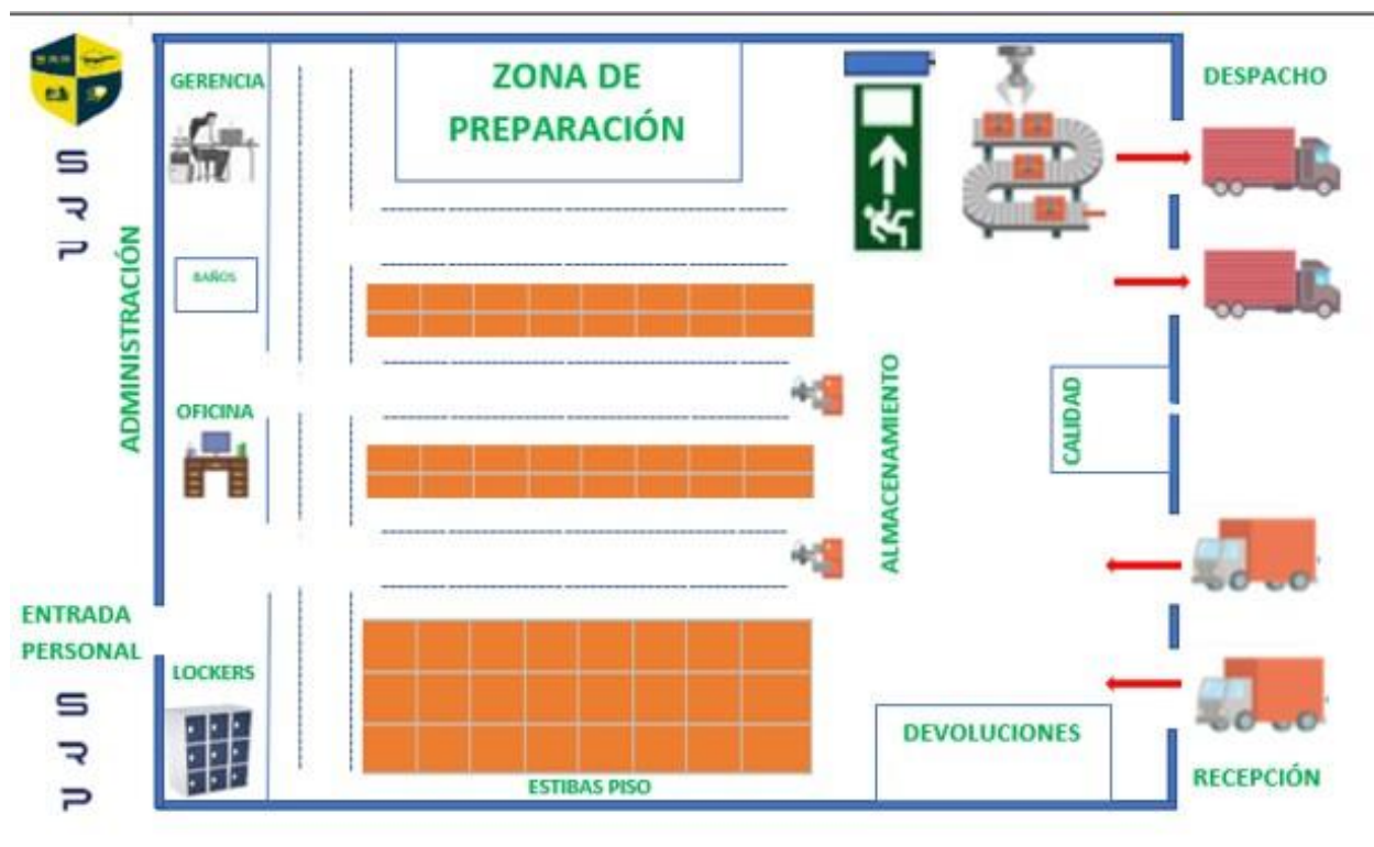
Ilustración 11. Layout mejorado de Sobre Ruedas SAS.
