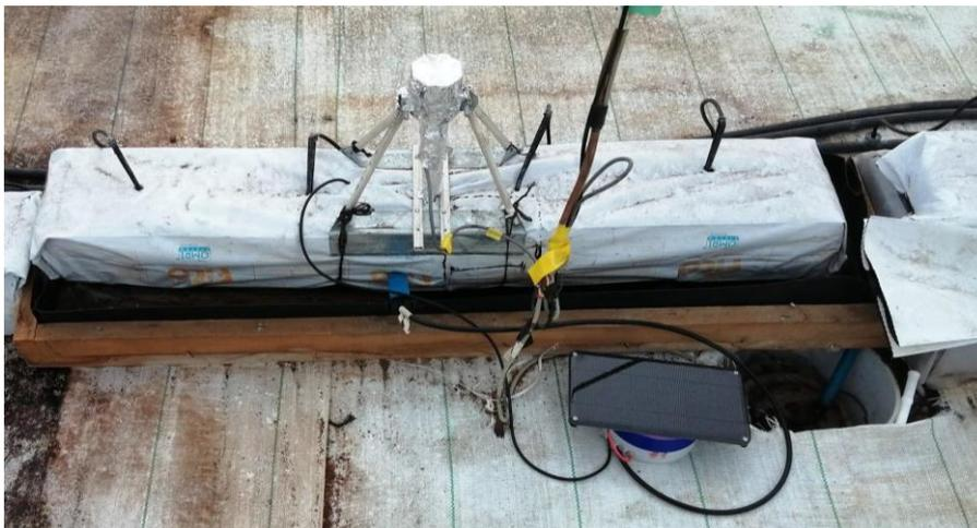
*Figura 10. Bandeja de riego a la demanda utilizada para el control del riego en el experimento.*
