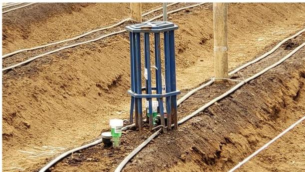
El temporizador del riego es un módulo que por medio de un cable recibe el pulso de cierre del tensiómetro y este pulso es usado como disparo “trigger” de inicio del tiempo “T1” de duración de riego activando un relay a 24 voltios de corriente alterna que energiza la válvula selenoide y permite el paso del agua de riego hacia el cultivo durante el tiempo T1.
