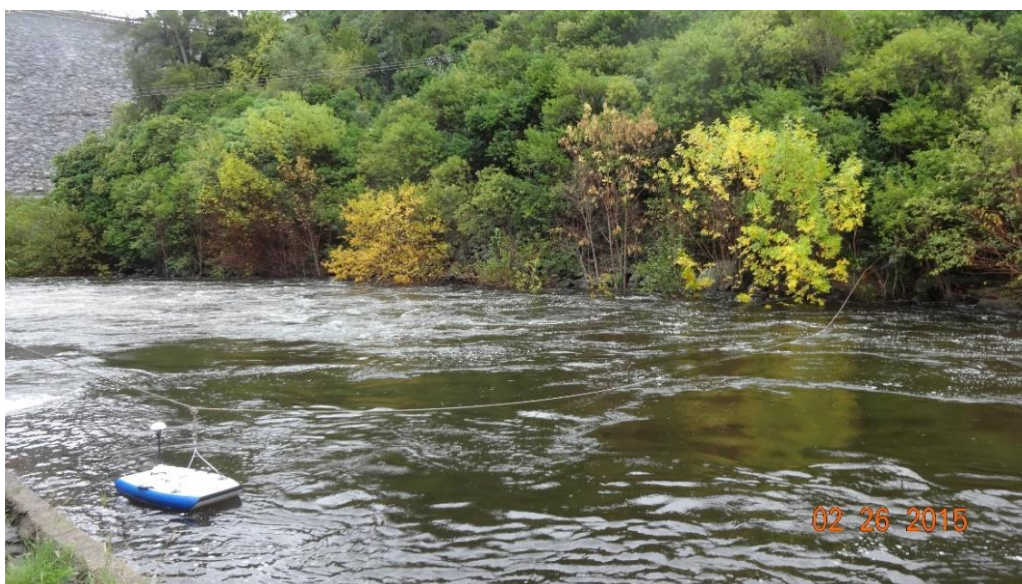
Figura 36.: Canal de fuga de la central Fitz Simon donde se realizaron los aforos mostrados en la Tabla 25. La foto corresponde a las mediciones efectuadas el día 26/02/2015
