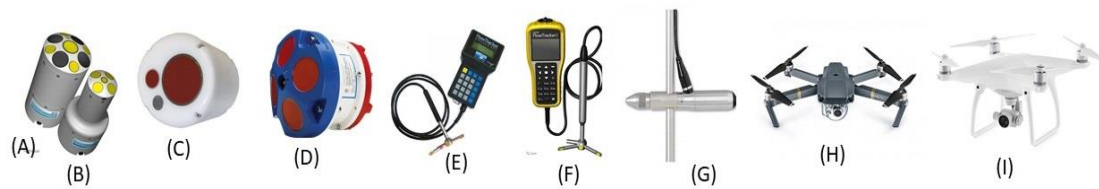
Figura 28.: Instrumentales utilizados en la regata. (A) ADCP SonTek M9; (B) ADCP SonTek S5; (C) ADCP RDI RiverRay; (D) ADCP RDI Rio Grande; (E) SonTek FlowTracker 1; (F) SonTek FlowTracker 2; (G) OTT ADC; (H) Mavic Pro DJI; (I) Phantom 4 DJI.
