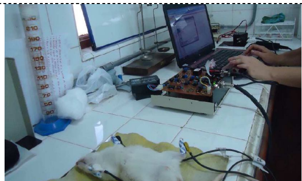
Figura 8. Adquisición de ECG para validación del equipo.
