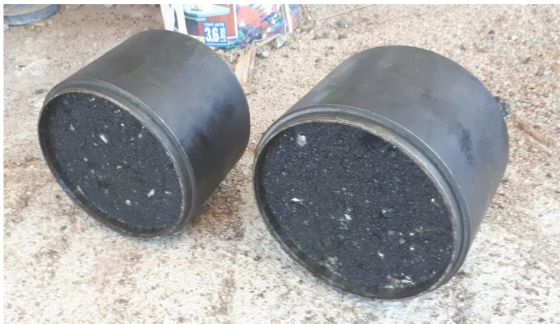
Figura 10-9: Confección de probetas de concreto asfáltico
