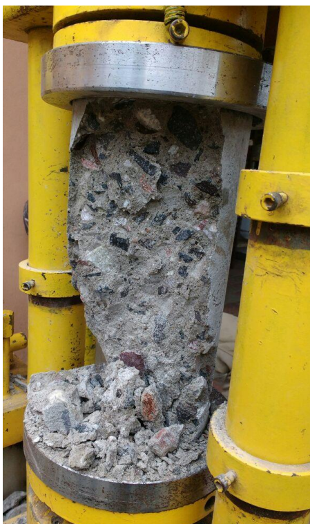
Figura 8-23: Ensayo a la compresión de probetas de hormigón
