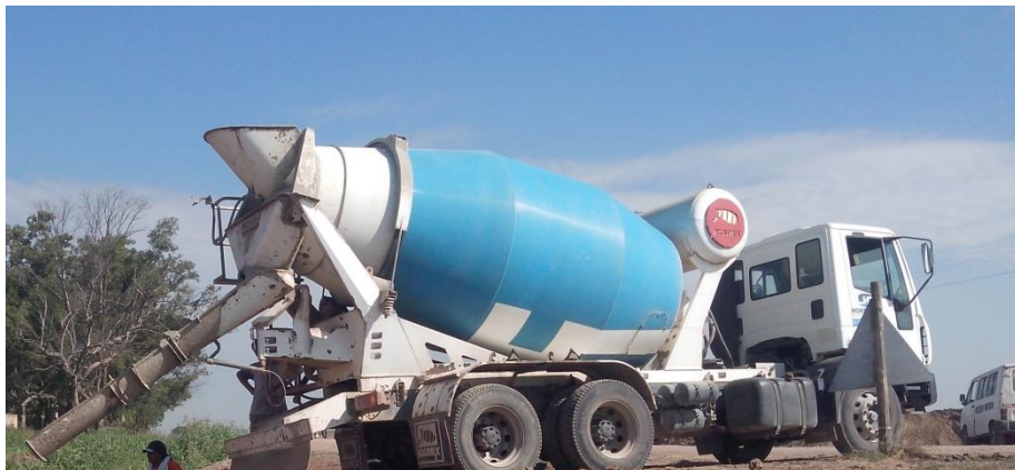
Figura 8-9: Camión con mixer para hormigón elaborado
