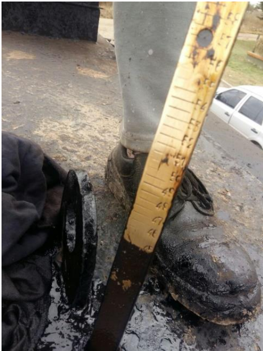
Figura 9-1: Medición de la cantidad de emulsión en el tanque del camión regador con varilla graduada
