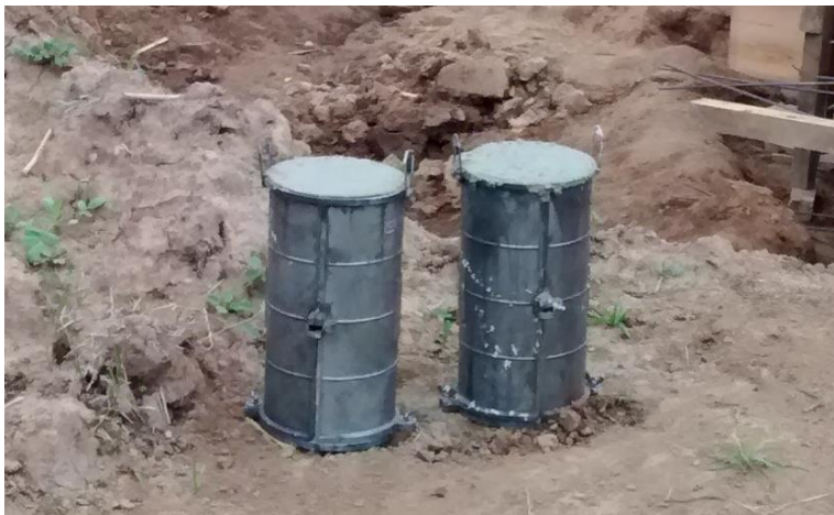
Figura 8-22: Confección de probetas
