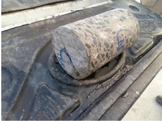
Figura 8-20: Testigo extraído del pavimento con su respectiva identificación
