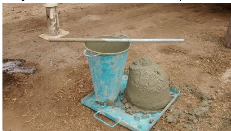
Figura 8-1: Determinación del asentamiento
