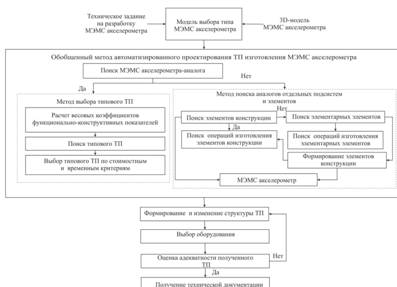
Рис. 1 Структурная модель обобщенного метода автоматизированного проектирования ТП изготовления МЭМС акселерометра
