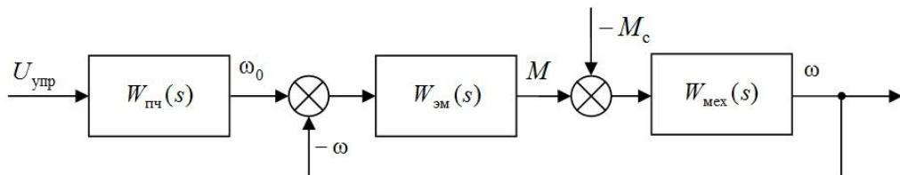
Рис. 1. Структурная схема электропривода
