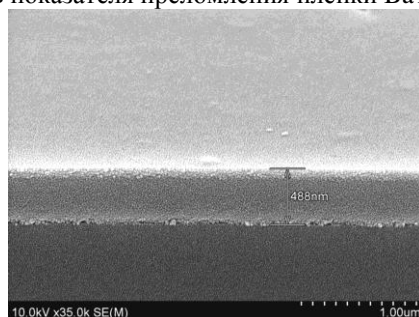
Рис. 3. РЭМ-изображение скола трехслойного образца \text{BaTiO}_3/\text{SiO}_2/\text{BaTiO}_3 на подложке кварца, слой \text{SiO}_2 наносился дважды подряд
