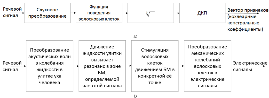
Рис. 3. Сравнение этапов обработки сигнала: а – схема рассматриваемого алгоритма экстракции; б – процесс обработки звукового сигнала в слуховой системе человека
