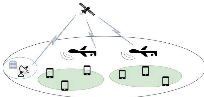
*Рисунок 5 - Схема организации спутниковой сети с помощью БПЛА*
