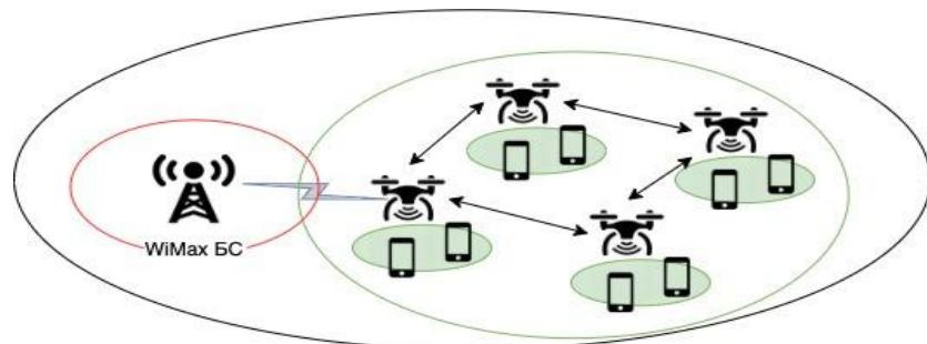
*Рисунок 3- Схема организации WiMax сети с помощью БПЛА*
