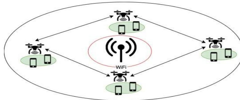
*Рисунок 4 - Схема организации Wi-Fi сети с помощью БПЛА*
