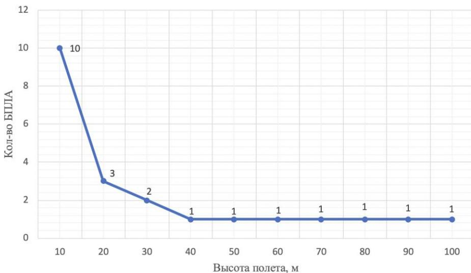
Рисунок 7 - График зависимости количества от высоты полета БПЛА при площади покрытия связью 1000 м<sup>2</sup>
