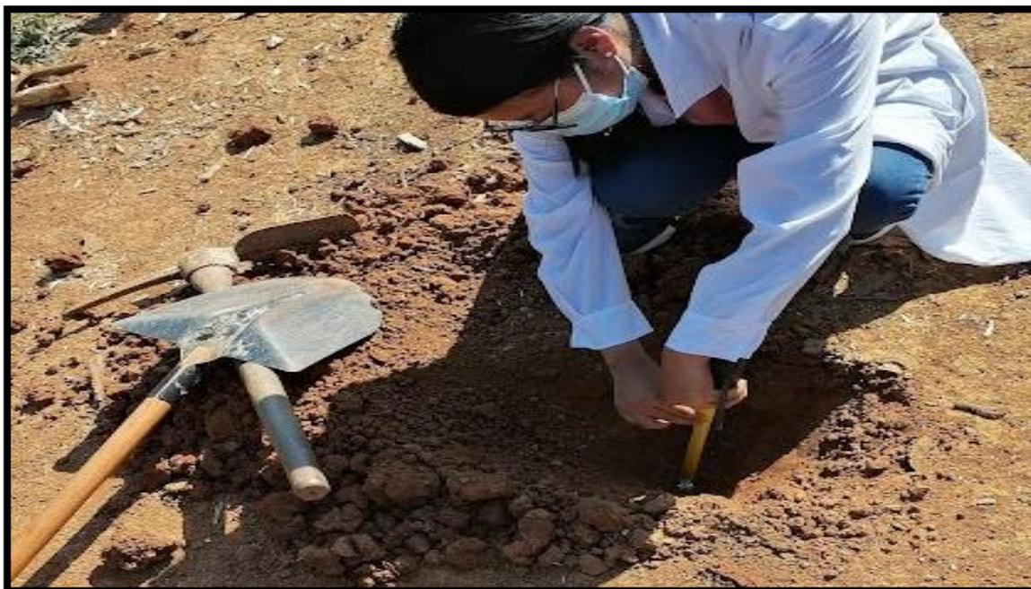
**Fotografía 2** Separación y homogenización de muestras mediante el método del cuarteo
