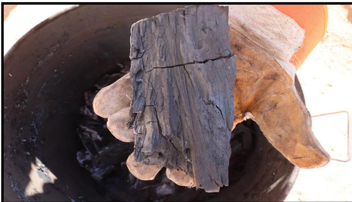
**Fotografía 8** Muestra de biochar de *Schinus molle* enviado al Laboratorio de Suelos de la Unas
