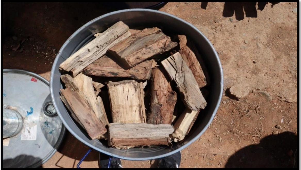
**Fotografía 4** Llenado de cilindro exterior del horno pirolítico con leñas para fuente de calor en la elaboración del biochar.
