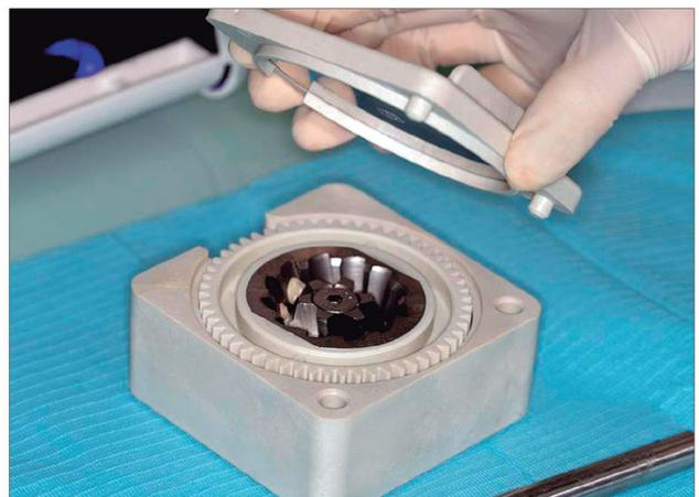
FIGURA 9 Partes independientes del triturador.
